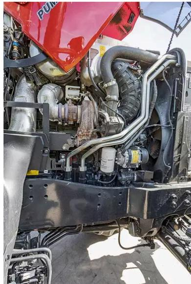
*Der FPT-Motor überzeugt bei Leistung und Verbrauch. Und er hat nur im 260er einen Turbolader mit variabler Geometrie. (Bildquelle: Tovornik)*
