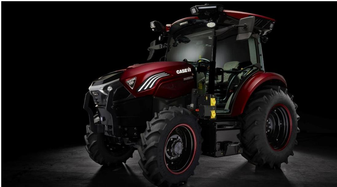
Der Farmall 75C Electric, der auf der letzten Agritechnica in Hannover dem Fachpublikum vorgestellt wurde, ist der erste vollelektrische Traktor von Case IH. Der Traktor verfügt über ein brandneues Design mit dieselähnlicher Leistung und ist mit zusätzlichen autonomen Betriebsfunktionen für die universelle Aufgaben in Landwirtschaft, kommunalen Betrieben, Industrie, Gewächshäusern oder auch leichte Forstarbeiten konzipiert.
