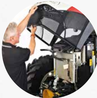
Le capot du moteur en une pièce à suspension à air comprimé peut être relevé à deux positions (45°/90°), même si un outil est monté à l'avant.
