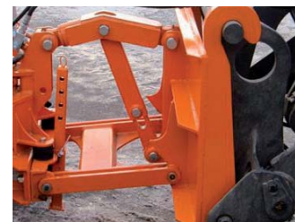
Ausgleichsstange für Schareinstel- lung und Querpendeleinrichtung
