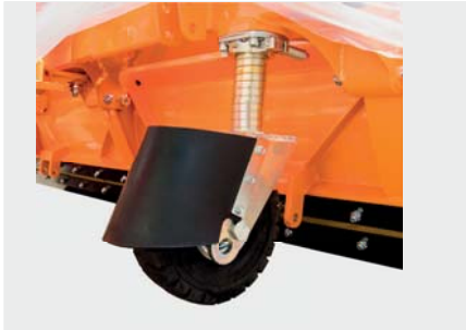
Nachlaufräder (Gr. I) Stufenlos höhenverstellbar durch eine Spindel, Vollgummi- oder Lufträder, Durchmesser 300 mm
