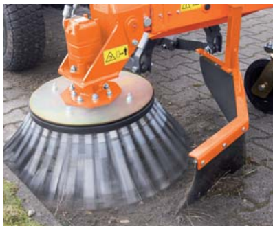
Flachdrahtbesen schneidet das Gras
