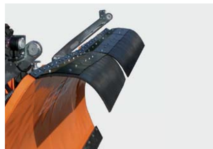
Schutzschirm aus Stahl-Gummielementen Überhangweite 400 mm um die Wurfweite des Schnees zu reduzieren
