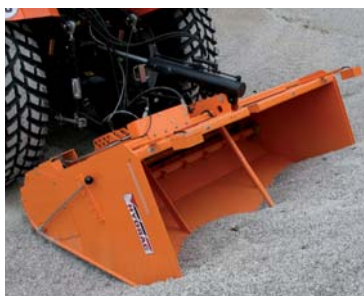
Selbstladeeinrichtung zum Befüllen des Korpus
