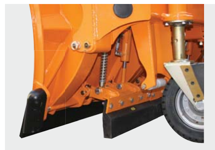
Nachputzleiste mit hydraulischer Aushebung Eine volle Ausklinkung der Nachputzleiste ist gewährleistet. (siehe Seite 7)
