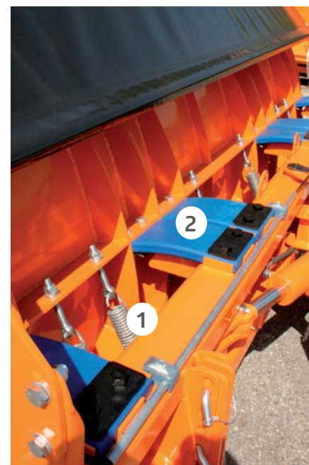
1 Nachstellbare Federn 2 Kunststoff-Schwinglenker
