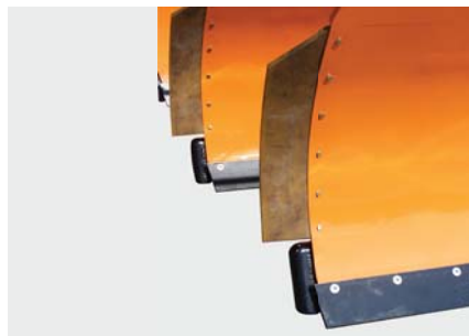
Leitplankenschutz Die seitliche Vulkanleiste schützt die Pflugschar vor Beschädigung
