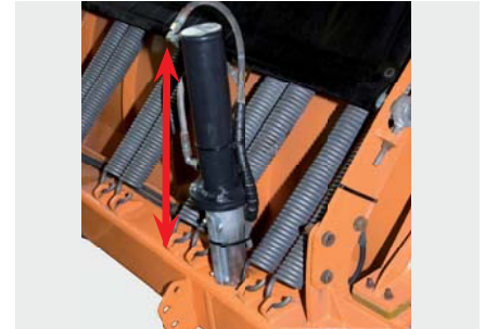
Hydraulisch verstellbare Räder Höhenverstellung der Nachlaufräder von der Kabine aus, ein doppelwirkendes Steuergerät not- wendig (oder Umschaltventil)
