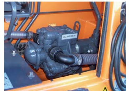
Wartungsfreundlich aufgebautes Flüssigkeitssystem, mit leistungsstarker Kolbenmembranpumpe
