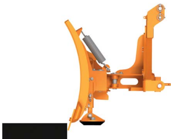
Klinkautomatik: Schild klinkt beim Anfahren nach vorne aus. Automatische Rückstellung durch einstellbare Federn.
