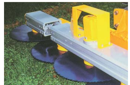
Rotierender Freischneider Schnittbreite bis 210 cm
