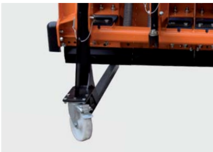
Abstellwagen Einfaches Rangieren des Schneepfluges
