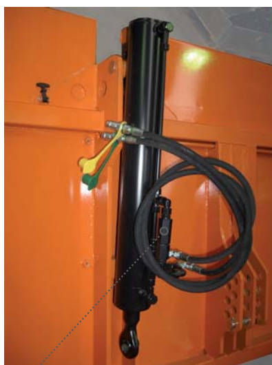
Hydraulischer Oberlenker mit ○ Rückschlagventil, für Selbstladeeinrichtung
