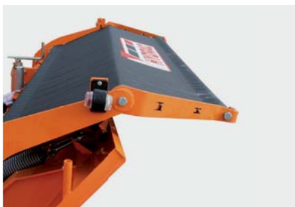
Schneestaubschutz Stufenlos verstellbare Plane, Überhangweite 400 mm, für Schneeerwehungen (Flugschnee) und auf Salzstrecken
