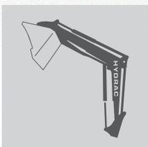
Die **Schaufel-Schnellentleerung mit Schwimmstellung** ermöglicht das schnellstmögliche Entleeren per Knopfdruck.
