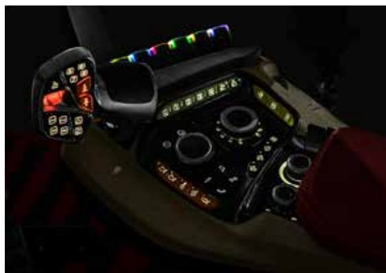
Les icônes de tous les interrupteurs sont rétro-éclairées lorsque les phares sont allumés.
