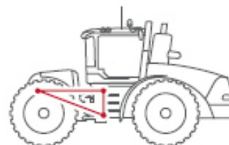
Articulation 3 points robuste : répartition idéale des efforts.*
