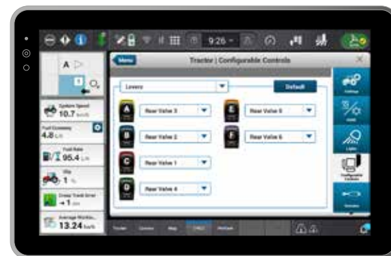
Un raccourci vous permet d'accéder directement au menu des paramètres pour configurer vos distributeurs auxiliaires.
