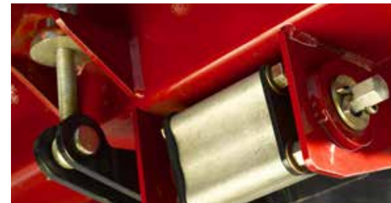
Verstellbare Torsionsblöcke steuern die Bewegung der Messer über den Boden.
