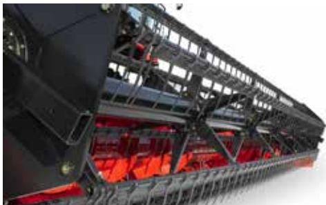
Die verstellbare Haspel kann mit Kunststoff- oder Stahlzinken ausgestattet werden.
