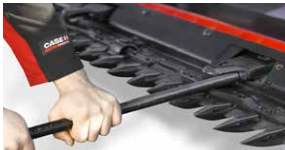
Problemlose Wartung des zentralen Messerantriebs
