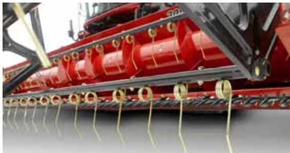
Besonderer Pluspunkt: Die Zinken reichen 7,5 cm unter die Messerleiste, heben das Erntegut an und reduzieren Schäden an den Messern.
