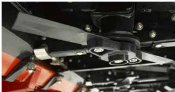
Das gesamte an den Walzen austretende Stroh wird gehäckselt.
