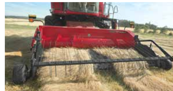
Der Schwad bleibt intakt, sodass es nicht zu Erntegutverlusten kommt.
