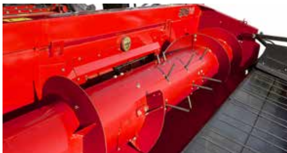
Dank ihres großen Durchmessers befördert die Schnecke auch sehr dichte Schwaden zuverlässig in den Mähdrescher.
