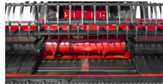
Beim mittleren Zuführband und der Schnecke lässt sich die Laufrichtung umkehren, um Blockierungen zu lösen.
