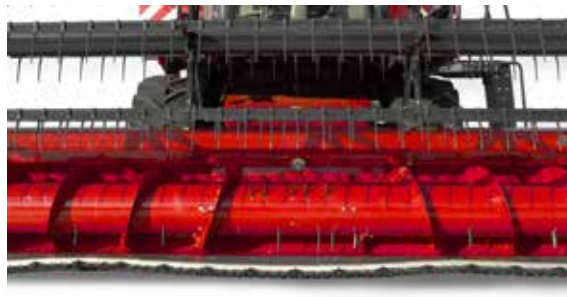
Die pendelnd gelagerten Messer folgen den Bodenkonturen, sodass jede Schote erfasst werden kann.
