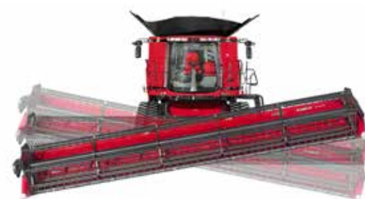
Mit dem Terrain-Tracker von Case IH bleibt die Stoppelhöhe auch auf kupierten Schlägen konstant.
