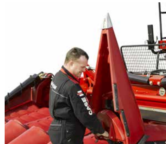
Für den Zugang zum Pflückaggregat den vorderen Teiler einfach mit einer Hand anheben
