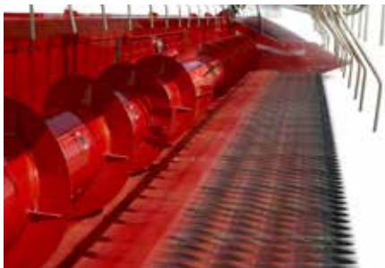
Vollhydraulische, variable Steuerung der Messerposition während der Fahrt von der Kabine aus (bis 575 mm).
