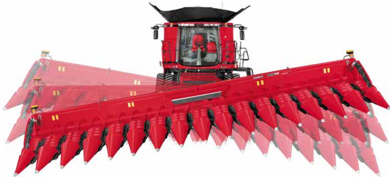
Mit dem Terrain-Tracker von Case IH bleibt die Stoppelhöhe auch auf kupperten Schlägen konstant.
