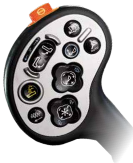
Aktivierung der automatischen Steuerung der Fahrgeschwindigkeit erfolgt mithilfe einer Taste am Multifunktionshebel.
