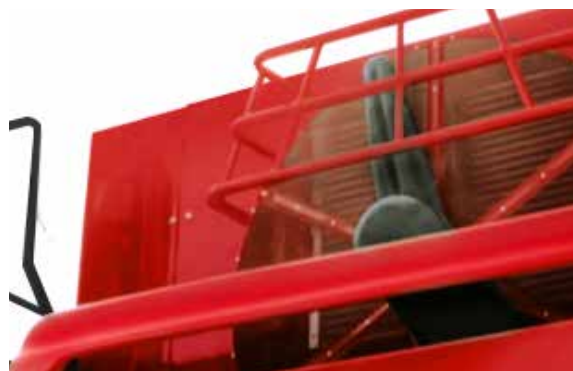
Fest montierter Kühlergrill für optimale Staubentfernung.
