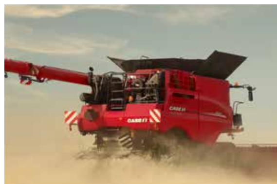
Spreuverteiler mit verschiedenen Verteilungsoptionen mit Streubreiten von bis zu 14 m.
