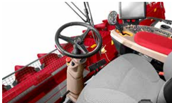
Klappbare Lenksäule mit neuem Notschalter und teleskopisch ausfahbarem Lenkrad – keine Sichtbehinderung.
