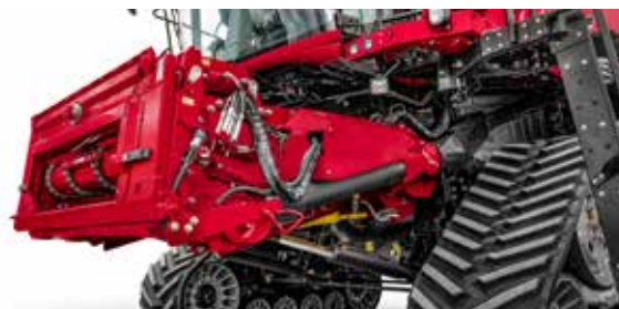
Inclinaison avant/arrière pour régler l'angle de barre de coupe – améliore le flux de la culture, minimisation des pertes.
