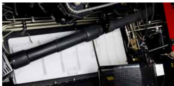
L'entraînement Power Plus transfère la puissance au convoyeur et la barre de coupe. Conception simple, entretien minime.
