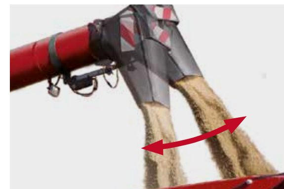
L'option d'embout pivotant est actionnée avec le levier multifonction. Elle oriente le flux de grains dans la benne et permet de la remplir au maximum sans débordement
