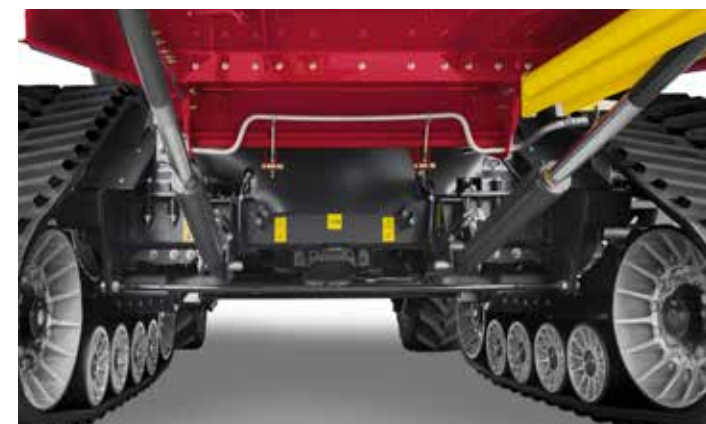
Vérins de levage déplacés, pour une plus grande capacité de levage. Doubles vérins de levage, pour un meilleur contrôle de hauteur de la barre de coupe.
