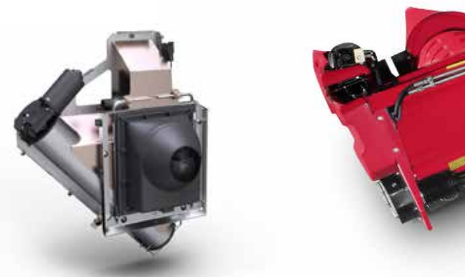
Caméra du grain pour évaluer la quantité d'impuretés et de grains cassés montant dans la trémie
