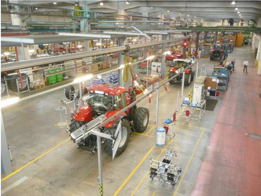
Durch Optimierungsmaßnahmen im WCM Prozess wurden die Wegstrecken für die Montagearbeiter um 75% reduziert.
