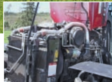
Le moteur de 117 CV avec injection Common-Rail et «Power Boost» de 24 CV.
