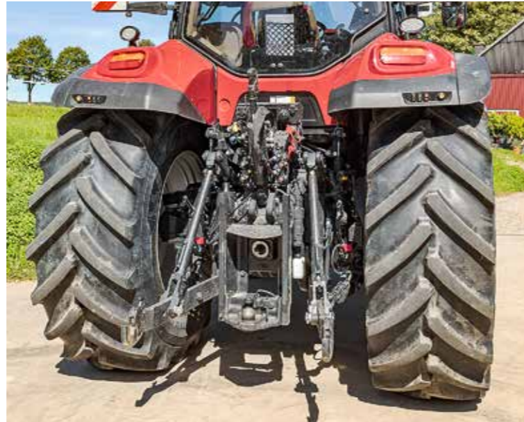
Hubkraft und Ölmenge sind gut, die Ordnung (Strom und Luft oben, Öl unten) passt auch. Hydraulische Seitenstabis sind prima, aber nicht nötig.
